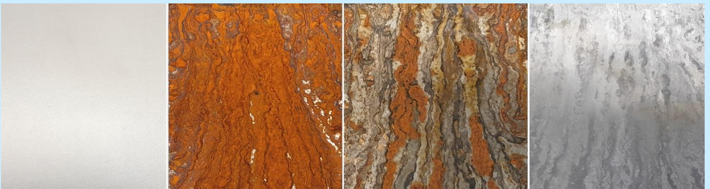
Massahäviön kehityskaari teräslevyillä. Vasemmalta oikealle: aloitustilanteen levy, levy 48 h korroosiotestin jälkeen, levy ensimmäisen putsauksen ja harjauksen jälkeen sekä levy koko prosessin jälkeen.
