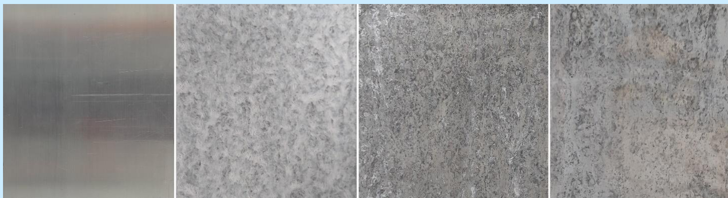
Massahäviön kehityskaari sinkkilevyillä. Vasemmalta oikealle: aloitustilanteen levy, levy 48 h korroosiotestin jälkeen, levy ensimmäisen putsauksen ja harjauksen jälkeen sekä levy koko prosessin jälkeen.
